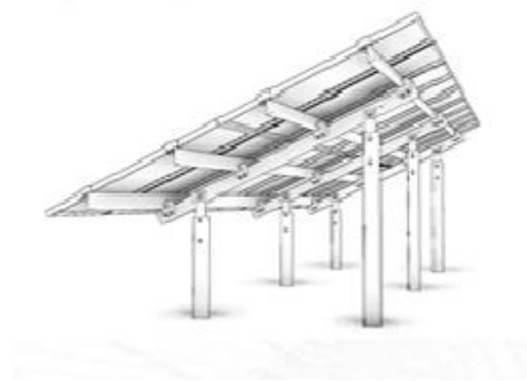
Exemplu de instalare pe structura cu 2 panouri asezate vertical
